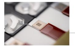
利用激光焊接技术将FPC(信号采集)与 母排连接
